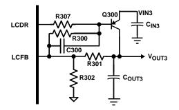
FIGURE 16. LINEAR COMPENSATION COMPONENTS
