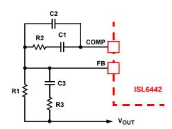
FIGURE 13. COMPENSATION CONFIGURATION FOR ISL6442 CIRCUIT
